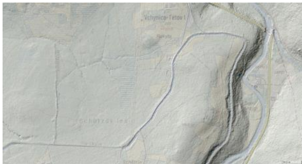
Obrázek 12 – Identifikace stopy Vchynicko-tetovského kanálu na lidarových snímcích (ZABAGED - Výškopis - DMR 5G) [13] V této části se jedná o dochovanou stopu kanálu, která v levé části přechází ve skluz na dřevo, jehož rovná trasa je překryta a na lidarových snímcích je tak lépe patrná.
